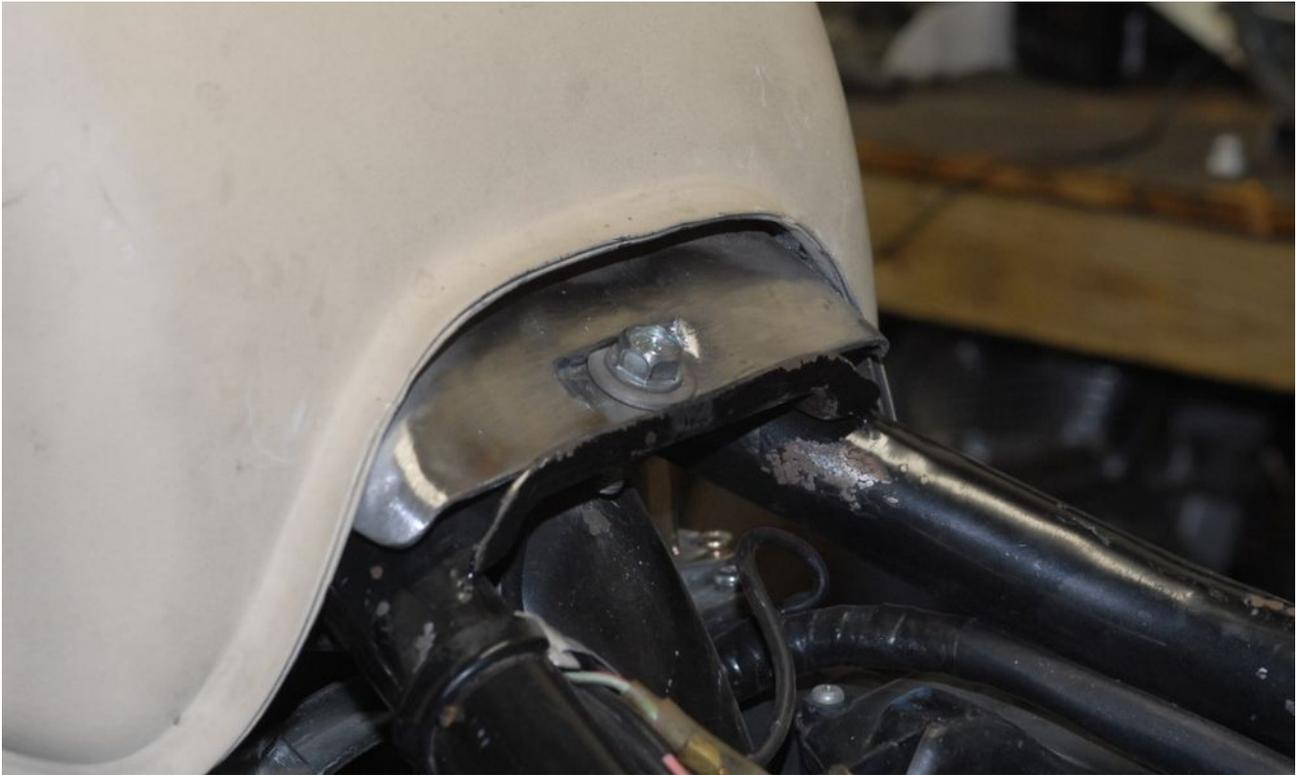
Um die Lasche weich zu lagern, nehme ich einfach ein Stück Gummi von der originalen Gummiauflage. Die Enden schneide ich ab, trimme das ganze zu einem Rechteck und schleife das dann auf eine Stärke von 3/8 Zoll (ca. 1 cm) herunter. Natürlich muss in die Mitte noch ein Loch für die Schraube gebohrt werden.
