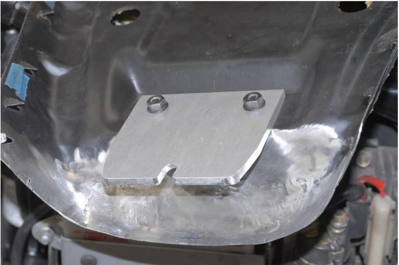
Um den Sitz weit genug nach unten zu bekommen, musste ich auf beiden Seiten der Befestigung eine Vertiefung einhämmern, diese resultiert aus der Auflage auf der erhöhten Lippe der Tankbefestigung.
