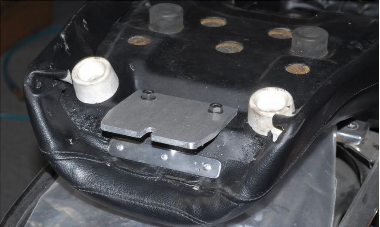
Zum Abschluss habe ich ein wenig Schaumstoff zur originalen Aufpolsterung hinzugefügt und alles passend zurechtgeschnitten. Das war fast der einfachste Arbeitsschritt.
