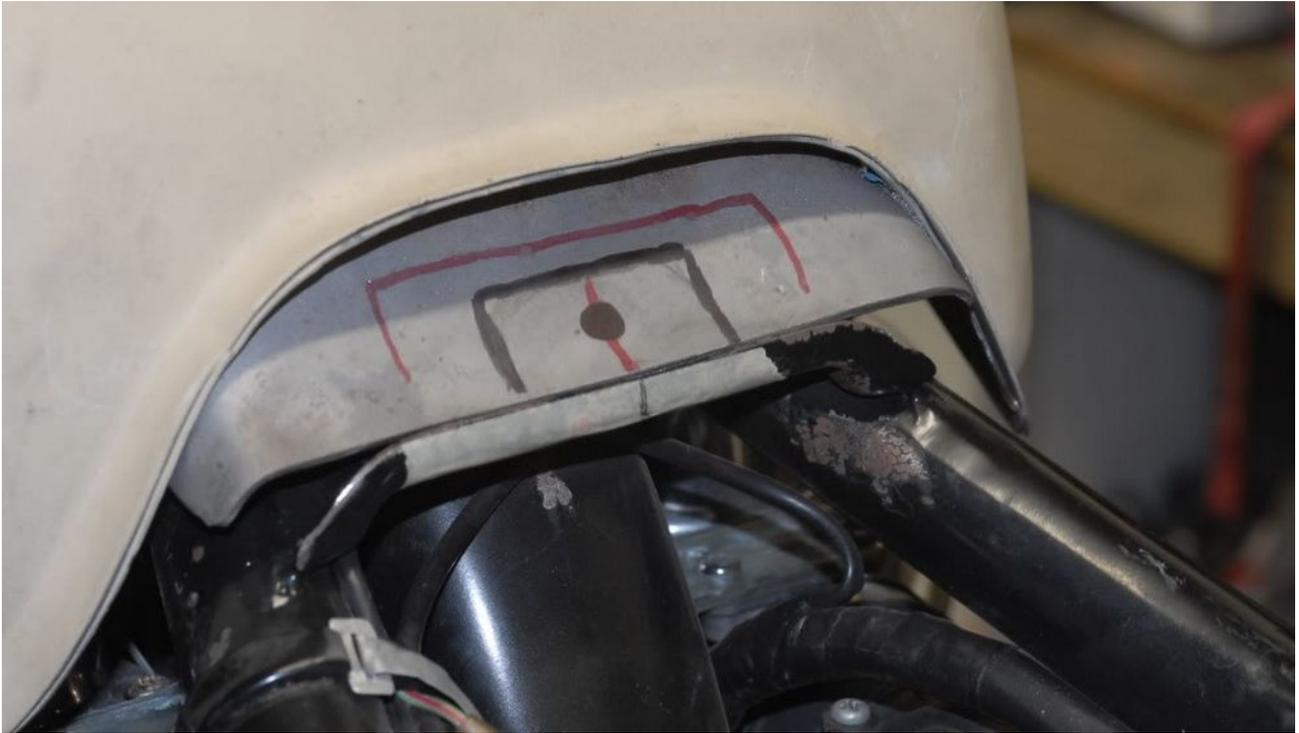
Ich schneide einfach eine Ecke aus einem Stück Vierkantröhr heraus, passe es genau an und schweiße es in die Lasche ein. Dann wird ein Loch hineingebohrt, dass mit dem im Rahmen in einer Linie liegt.
