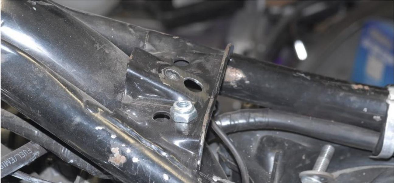
Damit der Tank später einfacher auf- und abgebaut werden kann, schweiße ich eine Mutter auf die Unterseite des Loches. Damit es serienmäßig erscheint, benutze ich ein metrisches Gewinde mit den Originalmaßen der ursprünglichen Tankbefestigung.
