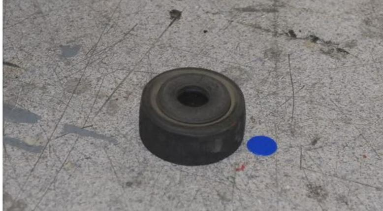
Ich schneide den Gummi auf etwas weniger als die Hälfte zu und benutze doppelseitiges Klebeband von 3M um ihn in der Tasche zu fixieren. Dieses Gummiteil sorgt dafür, dass der Tank weit genug hinten bleibt, damit die Gabel bei vollem Einschlag nicht anschlägt. Wenn Du dich mit größerem Abstand sicherer fühlst, kannst Du den Gummi genau hälftig teilen und so anpassen, wie Du es möchtest.
