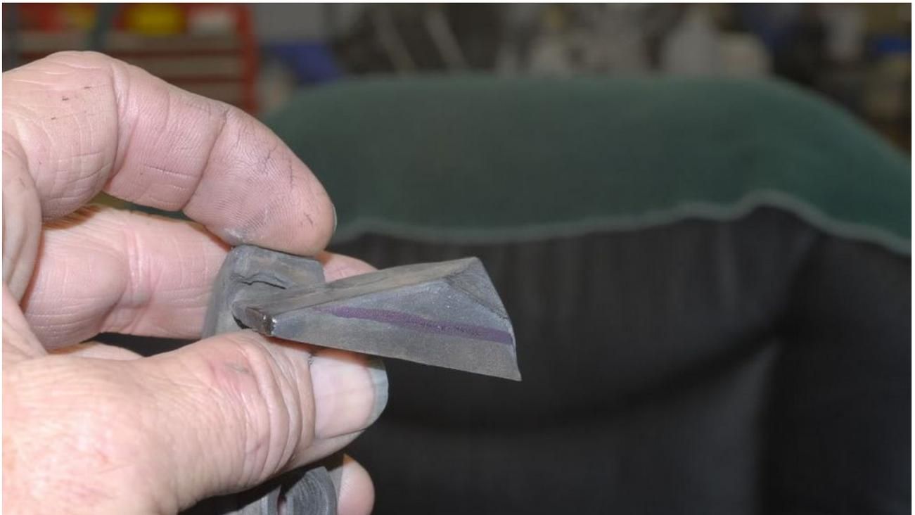
Soweit also die Montage eines Standard-Tanks auf eine C. Wie gesagt, man kann auch ein keilförmiges Gummistück für die hintere Halterung benutzen und spart damit das Schweißen und Anpassen des Metallstücks, aber nach meiner Auffassung ist die gezeigte Vorgehensweise sauberer und es hat sich herausgestellt, dass die Sitzbank der C leichter montiert werden kann. Und dazu komme ich jetzt.
