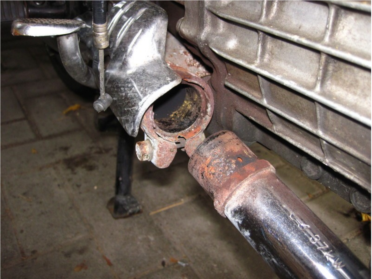
Auf dem Bild ist die Dichtung in der Mündung des Sammlers sehr gut zu erkennen.
