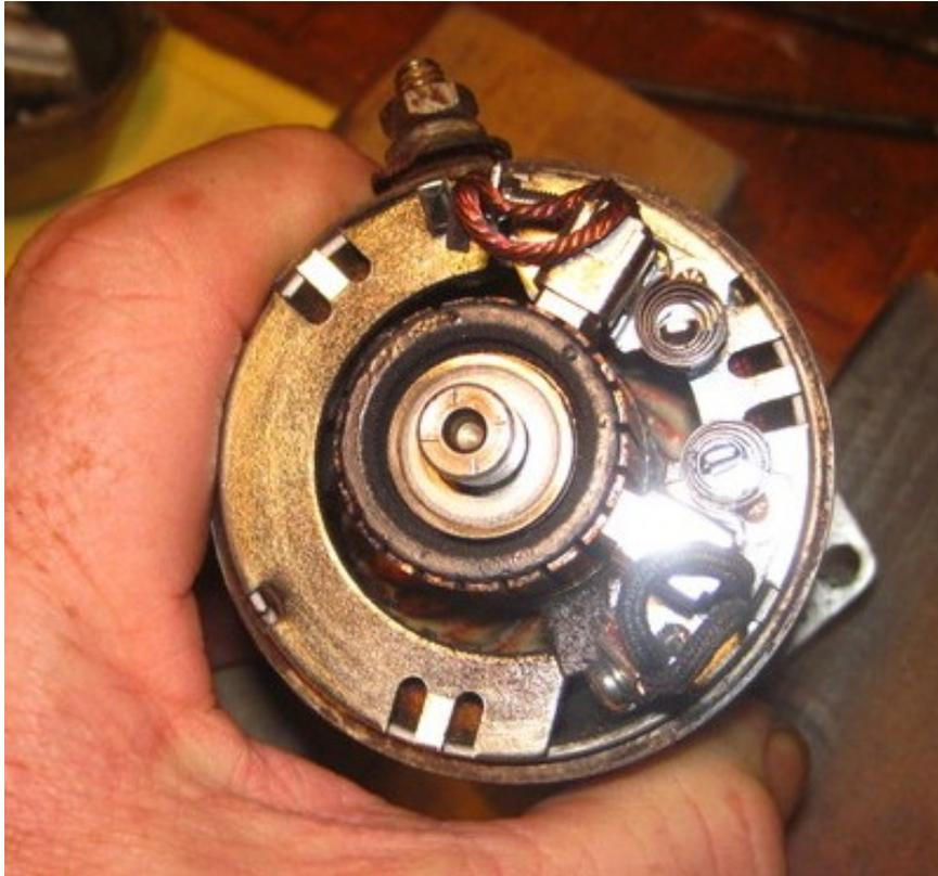
Rechts die Plus-Kohle in der Seitansicht. Die Zuleitung kommt von unten aus dem Gehäusemittelteil.
