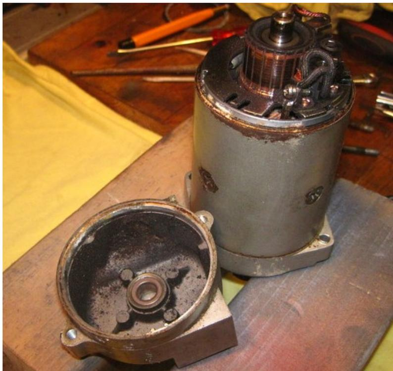
Sind die Schrauben gelöst, läßt sich der hintere Gehäusedeckel einfach abnehmen. Er ist mit Abrieb von den Kohlen verschmutzt.
