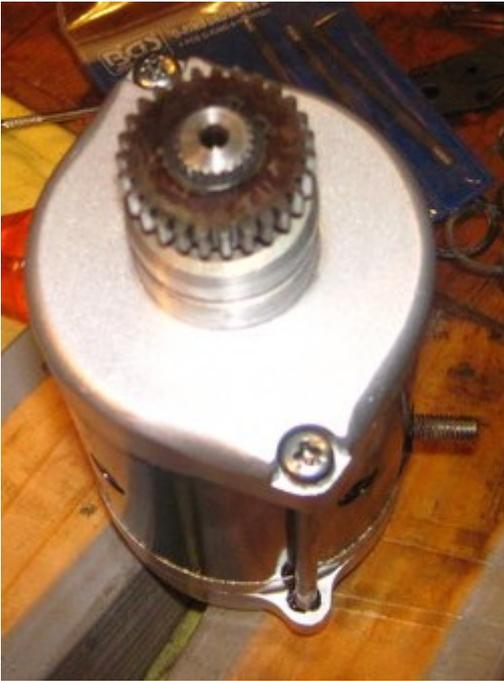
Jetzt wird noch das Anlasserritzel aufgesetzt und mit dem Sprengring fixiert.
