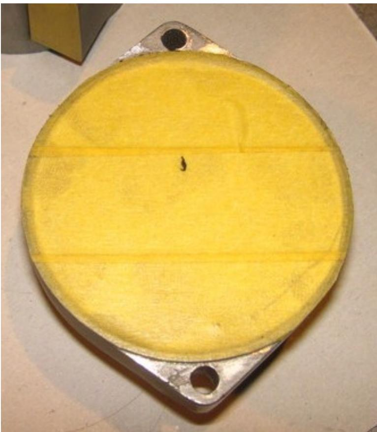
Der vordere Zylinder ist werksseitig auch nicht lackiert und wird ebenfalls abgeklebt.
