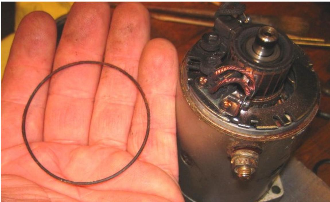
Es handelt sich um einen O-Ring 60 x 1,4. Wenn diese O-Ringe nicht mehr dichten, dringt Feuchtigkeit in den Anlasser ein und die Kontaktflächen des Massekontaktes beginnen zu oxidieren. Das führt zu einer Verschlechterung des Massekontaktes, was wiederum dazu führt, dass der Anlasser beim Starten wie abgewürgt klingt. Dann ist es Zeit den Anlasser auszubauen und zu reinigen!
