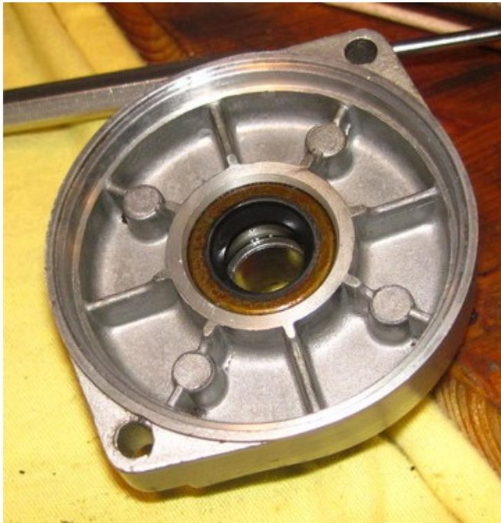
Ich möchte den Rost auf dem Mittelteil entfernen und den Anlasser neu lackieren. Auf dem Foto ist die Markierung zu sehen, mit der der Mittelteil und der hintere Gehäusedeckel zueinander ausgerichtet werden.
