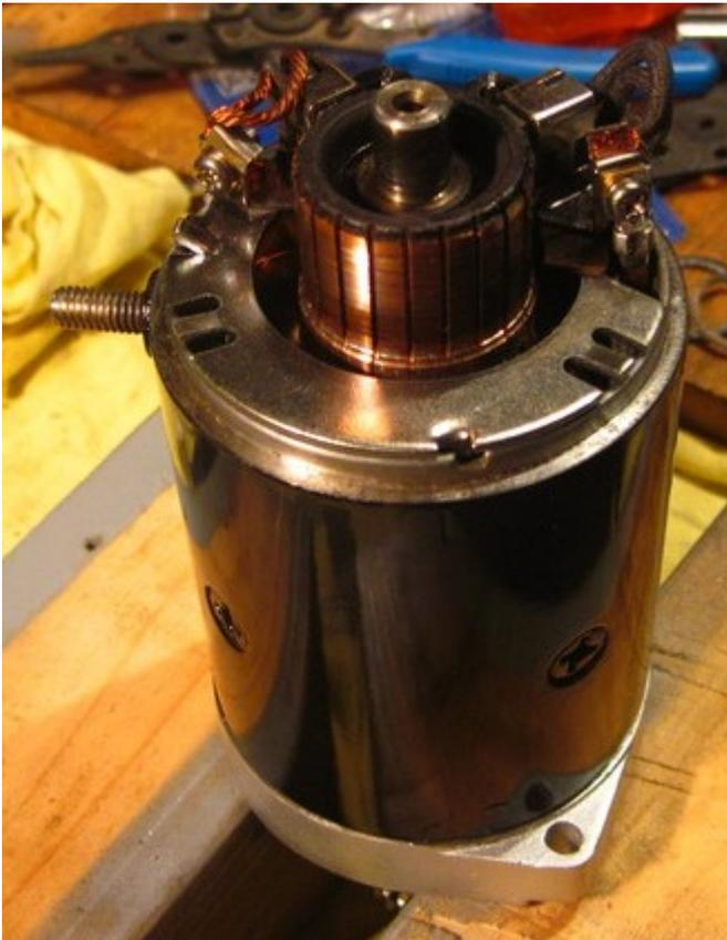
Die vorderen Scheiben werden auf die Achse gesteckt und die Achse in den vorderen Gehäusedeckel. Dann wird das Mittelteil auf den Rotor geschoben und stabil abgestellt. Die Kohlenträgerplatte wird aufgesetzt und zentriert und dann der Plus-Kontakt mit der kleinen Schraube fixiert.
