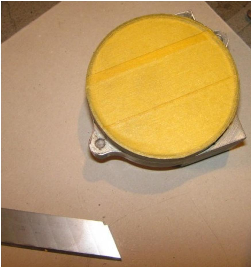
Dann habe ich den Deckel umgedreht auf die Pappe gelegt und das überstehende Klebeband mit der Klinge eines Cuttermessers randnah abgeschnitten.
