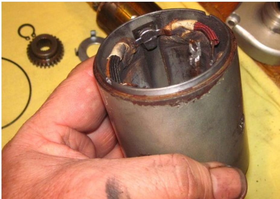
Sehr gut ist der Verlauf der Kabel vom Plus-Anschluss zu erkennen. Grobmotoriker,
