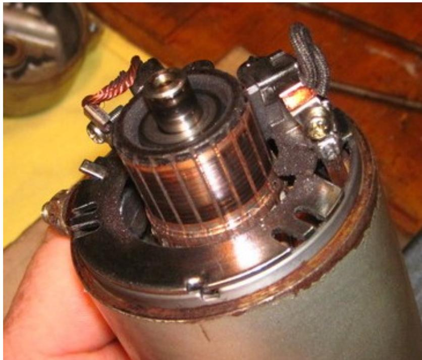
Die Zuleitung der Masse-Kohle wird mit einem Haltepunkt der Kohlenträgerplatte verschraubt.
