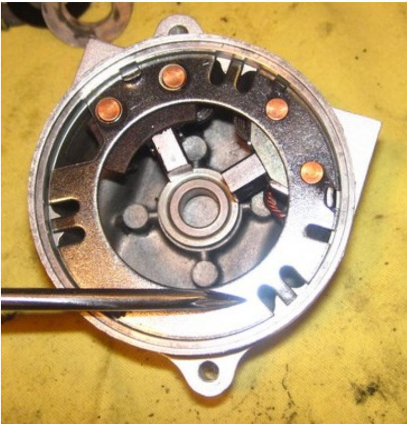
So liegt der Kohlen-träger im hinteren Gehäusedeckel auf. Die Kontaktzungen drücken mit ihren Außenkanten auf die Kontaktflächen.
