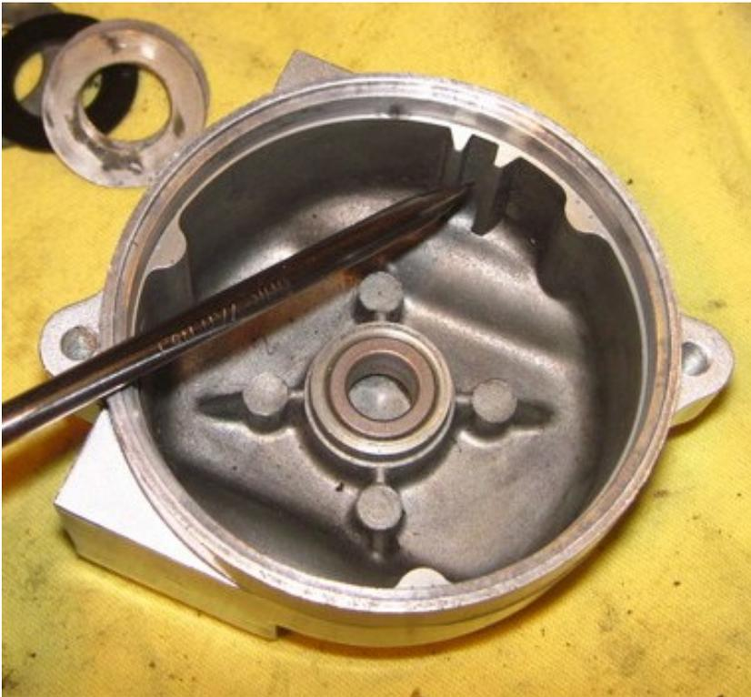
In dieser Nut im hinteren Gehäusedeckel wird die Kohleträgerplatte fixiert.
