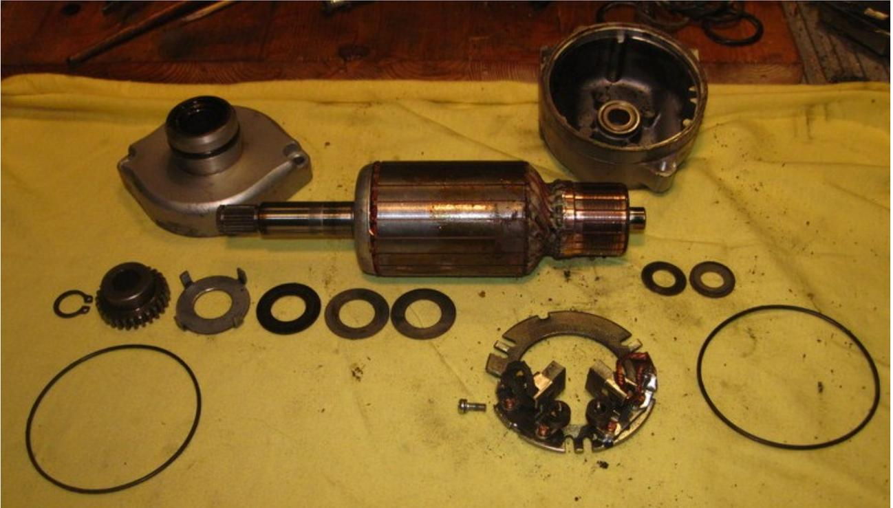
Die Scheiben werden so auf die Achse gesteckt, dass die dünnen Scheiben am Anker sitzen und die dicken Scheiben zu den Gehäusedeckel hin nach außen kommen. Dann werden die O-Ringe auf den Mittelteil des Gehäuses gesetzt. Ich habe die O-Ringe und die Nut mit Armaturenfett (Sanitärvaseline) gefettet. Das Zeug ist hitzefest bis 130°. *Die Lagerbuchsen in den Gehäusedeckeln bekamen einige Spritzer Spühfett (siehe letztes Bild)*
