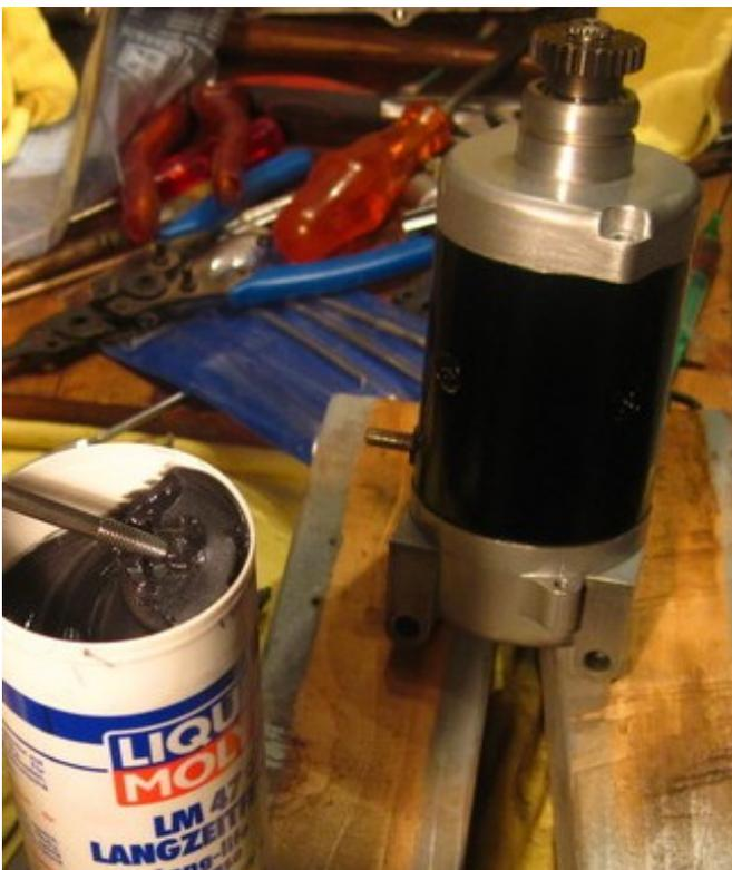
Jetzt wird der Anlasser umgedreht. Er kann jetzt zusammenschraubt werden. Die Stellung des hinteren Gehäusedeckel gibt die Ausrichtung des vorderen Gehäusedeckels vor!
