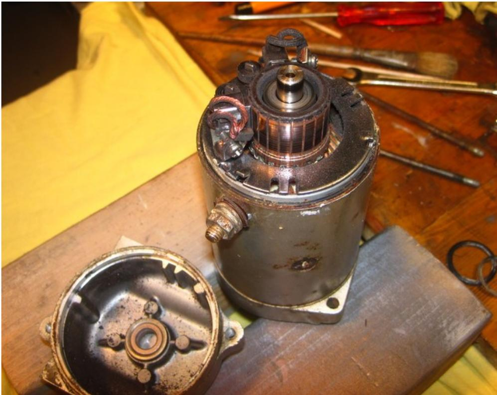
Die Ableitung der Massekohle ist direkt mit der Kohleträgerplatte verschraubt.
