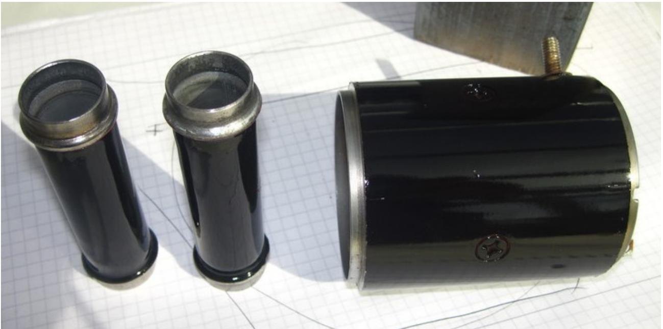
Während die Wasserrohre gut geworden sind, sah die Lackierung des Mittelteils nur auf dem ersten Blick gut aus. Ich hatte die geschliffene Oberfläche nicht ausreichend
