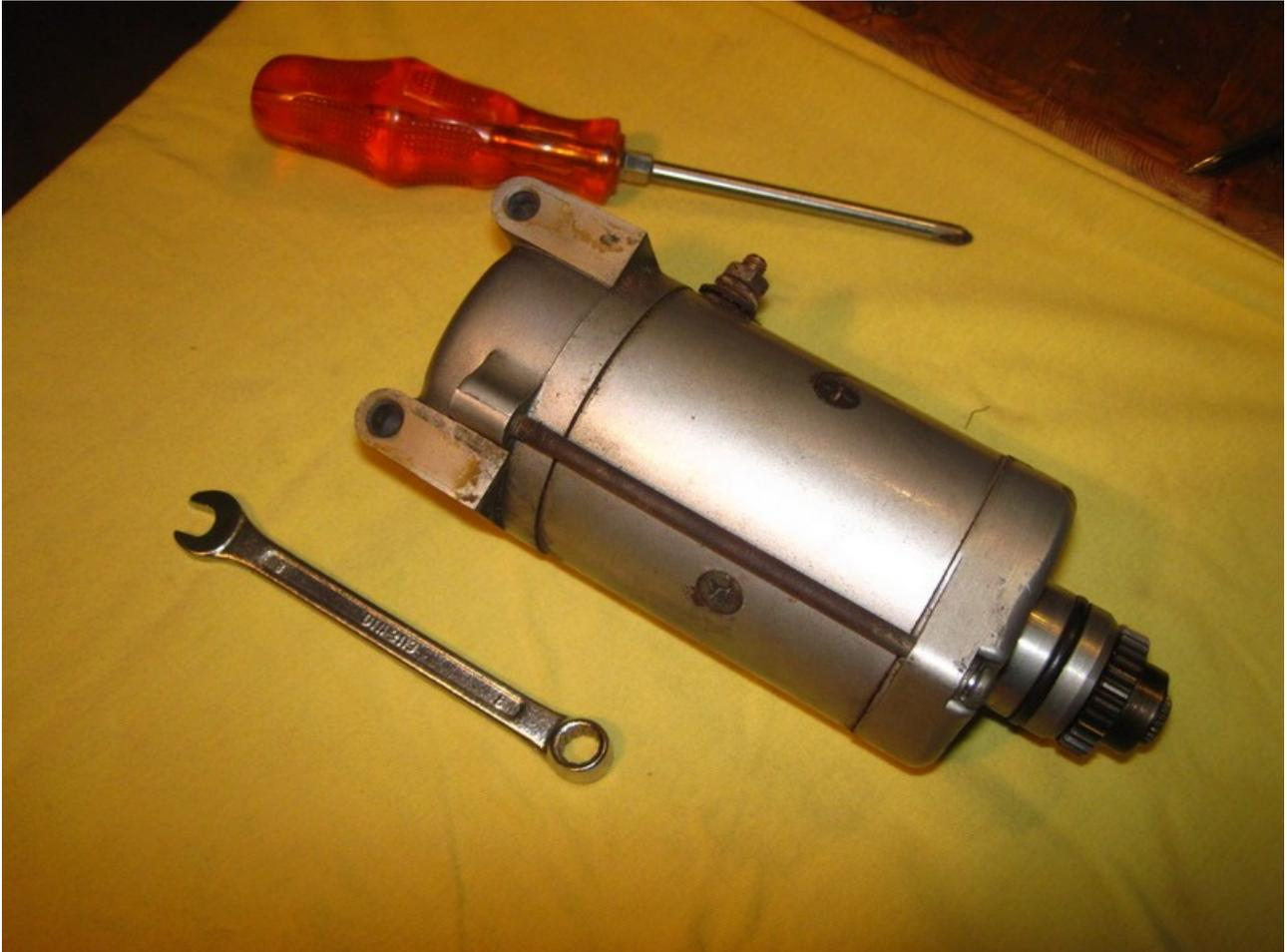
Man hat aber auch die Möglichkeit über die Schraubenlöcher, mit denen der Anlasser mit dem Winkelstück verbunden wird, diesen provisorisch zu sichern.
