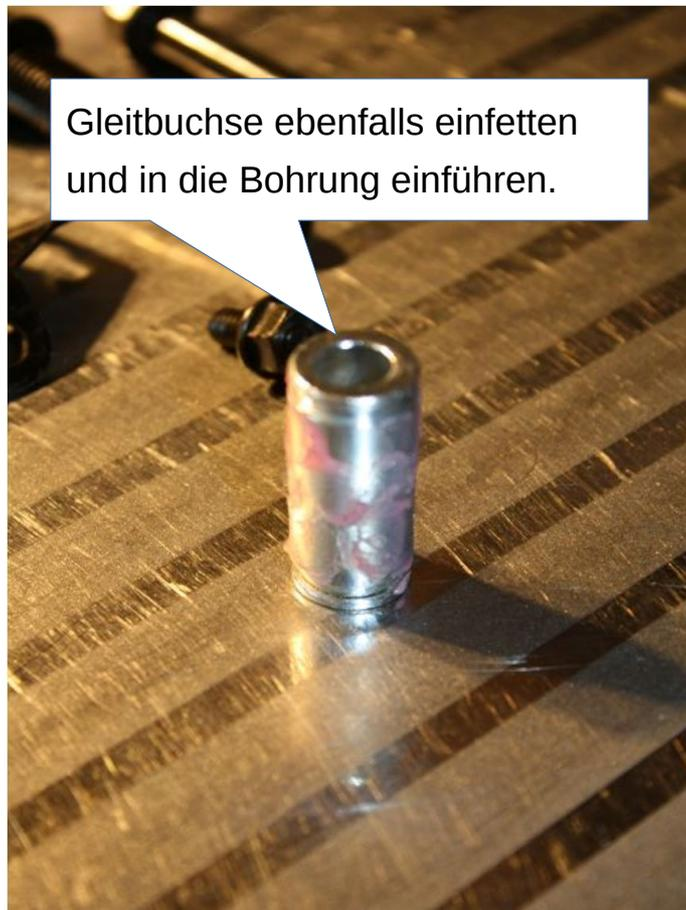
Gleitbuchse ebenfalls einfetten und in die Bohrung einführen.
