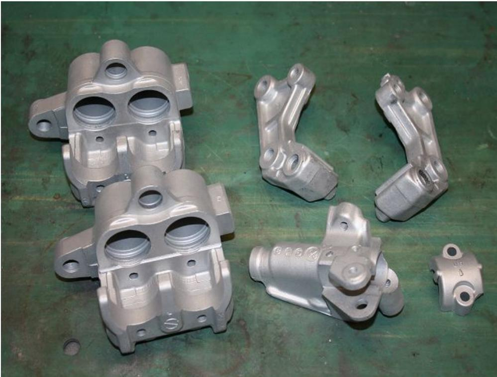
Jetzt werden alle Bohrungen mittels Stopfen und die Gewinde mittels passender Schrauben verschlossen. Der erste Strahlvorgang erfolgt mit grobem Strahlmittel, damit der spätere Lack besser hält und eventuelle Lackreste, die nicht durch die Beize entfernt wurden, jetzt entfernt
