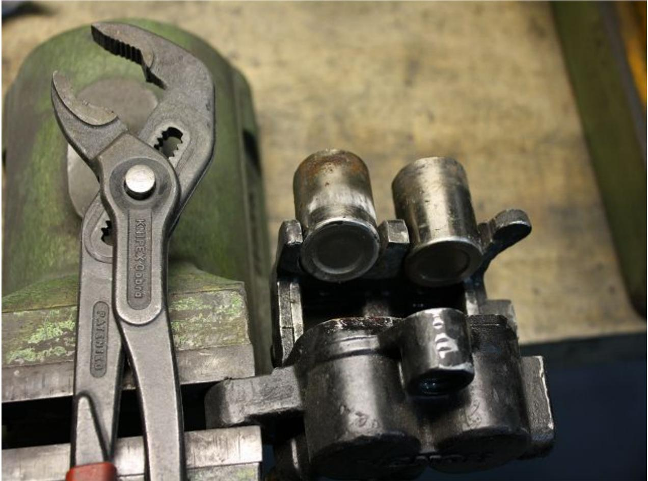
Mittels Wasserpumpenzange können unter leichtem Drehen die Kolben komplett aus dem Bremssattel entfernt werden. Das setzt natürlich voraus, dass man das Winkelstück entfernt hat.
