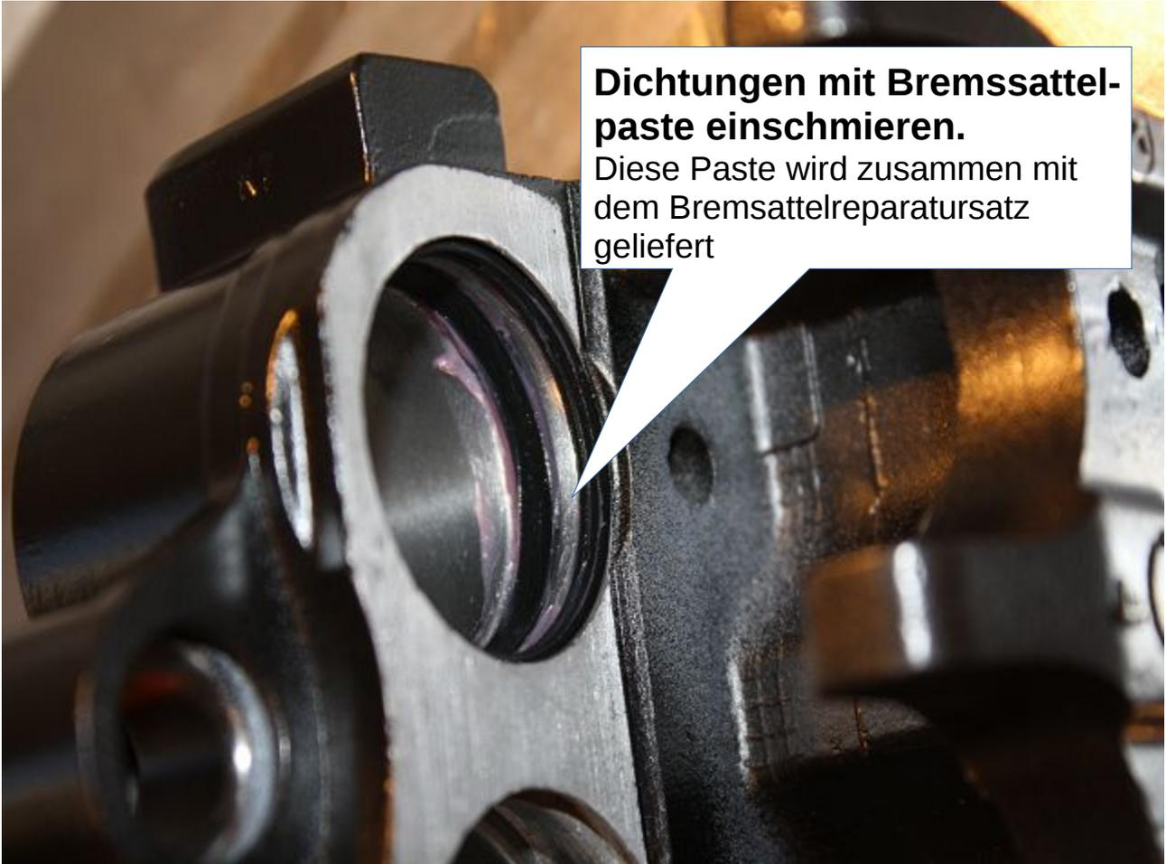
**Dichtungen mit Bremsattel-paste einschmieren.**
