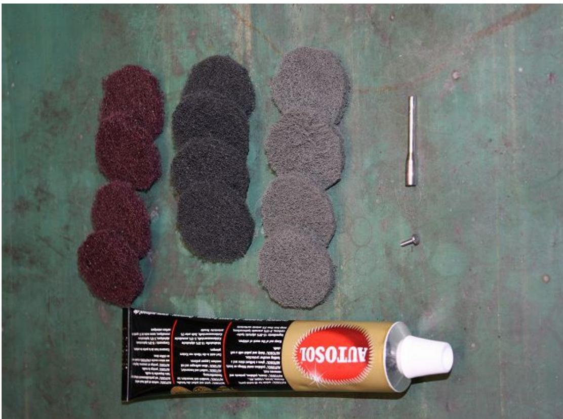
Jetzt werden mittels mittel / feinem Schleifvlies und Politur die Bohrungen und Zylinder poliert. Hier geht es nicht darum, hochglanzpolierte Oberflächen zu
