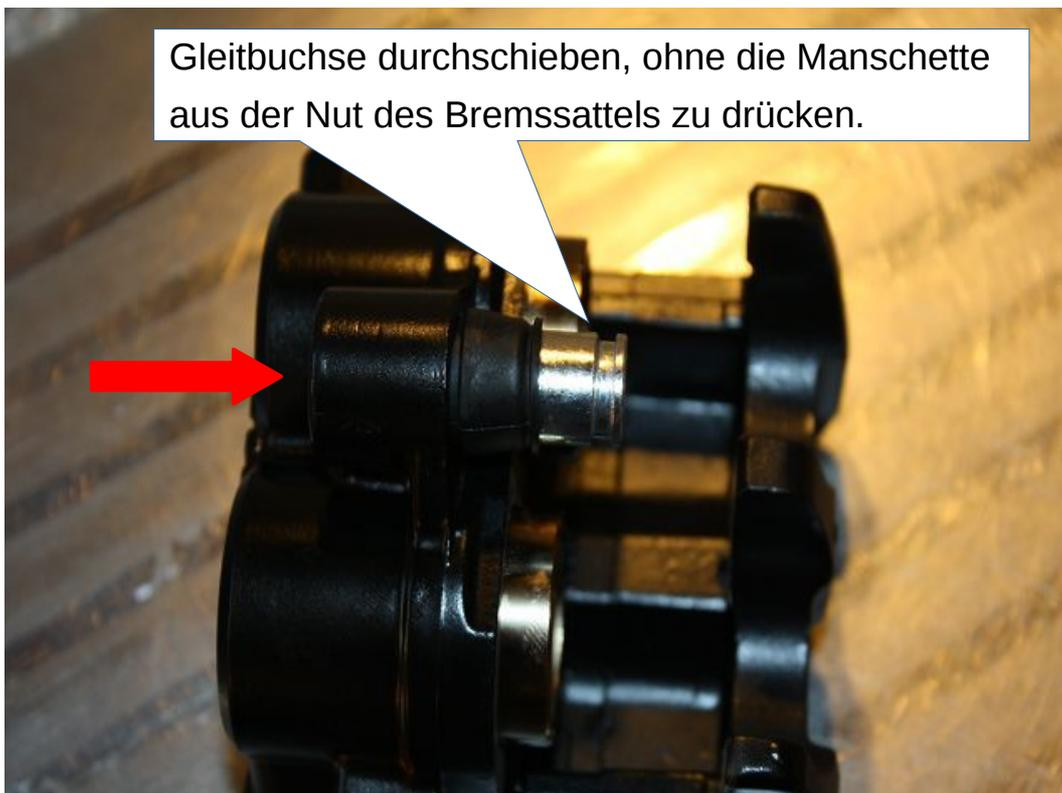
Gleitbuchse durchschieben, ohne die Manschette aus der Nut des Bremssattels zu drücken.
