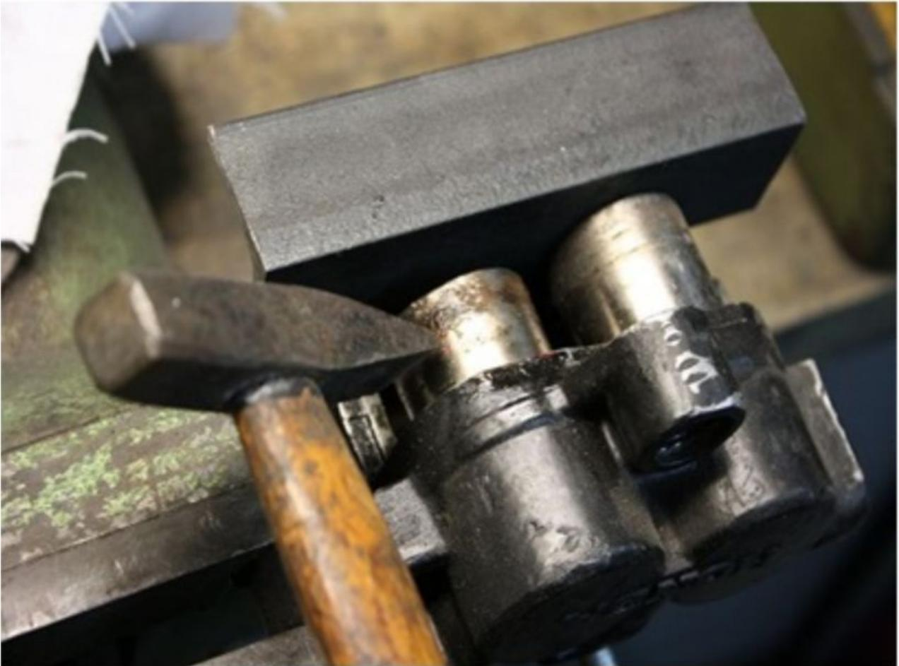
Erzielt man mit dem Kunststoffhammer keinen Erfolg, so sollte man jetzt auf einem normalen Schlosserhammer wechseln. Mit der schmalen Seite (Finne) des Hammerkopfes in kurzen Intervallen auf den Bremskolben schlagen. Normalerweise kann man jetzt beobachten, dass sich der Kolben stückweise aus seinem Zylinder bewegt.
