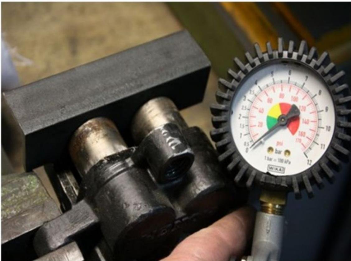
Bevor man versucht die Kolben aus dem Bremssattel zu entfernen, entspannt man über das Ventil am Pressluftwerkzeug das ganze System! Der Kompressor wird abgeschaltet und das Pressluftwerkzeug vom Bremssattel abgeschraubt.
