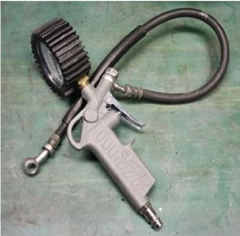
Dies ist ein Reifendruckluftprüfer bzw. eine Druckluftpistole um Reifen mit Pressluft zu füllen. Dieses Werkzeug wurde umgebaut, indem man den Druckluftschlauch gegen einen alten Bremsschlauch getauscht hat. Somit hat man jetzt die Möglichkeit, mittels dieses Schlauchs eine 100% dichte Verbindung zu schaffen.
