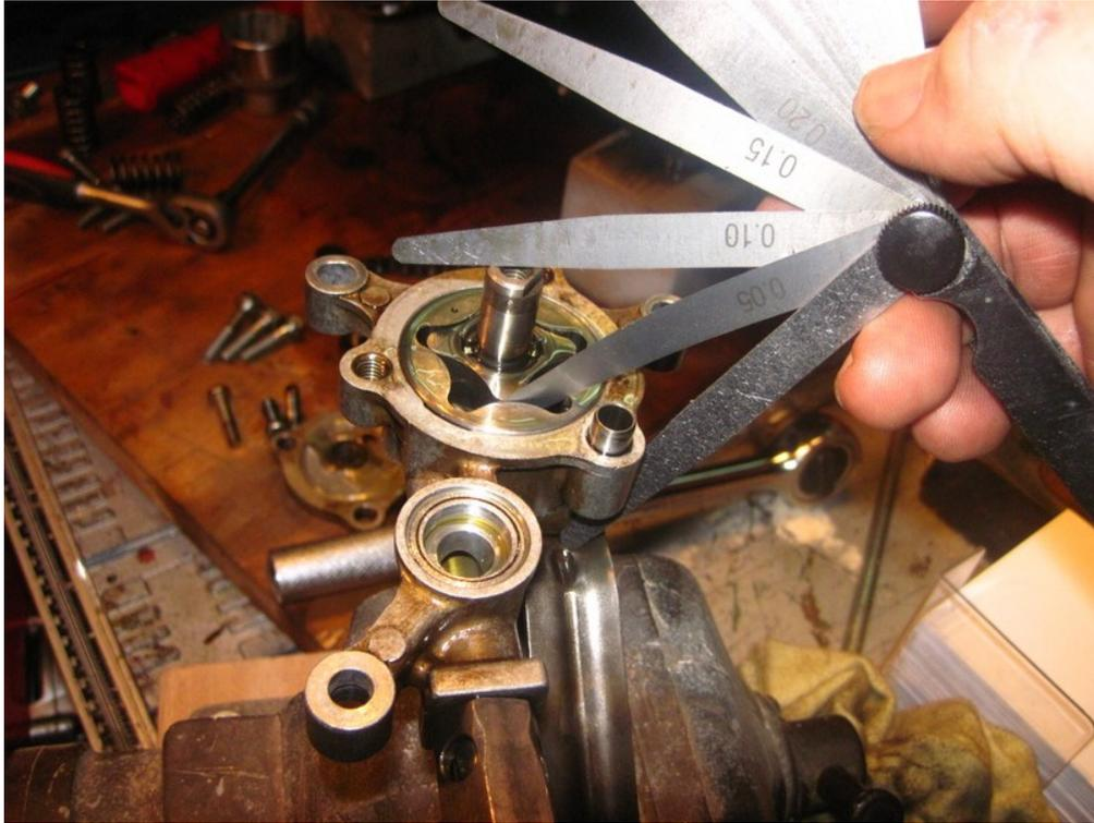
Als nächstes wird der Spalt zwischen dem Zylinder und dem Gehäuse der Ölpumpe gemessen. Das Verschleißmaß wäre 0,35 mm.
