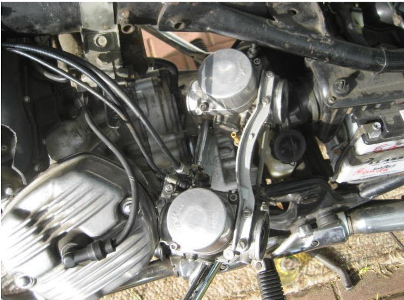
Nun geht es daran, die drei Züge von den Vergasern zu trennen. Dazu sind die entsprechenden Klemmungen zu lösen und die Nippel aus den Augen zu drücken. Et voilà, die Vergaser sind frei!
