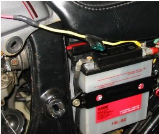
Der Kabelschuh des gelben Kabelstücks wird also am Pluspol der Batterie angeschraubt.
