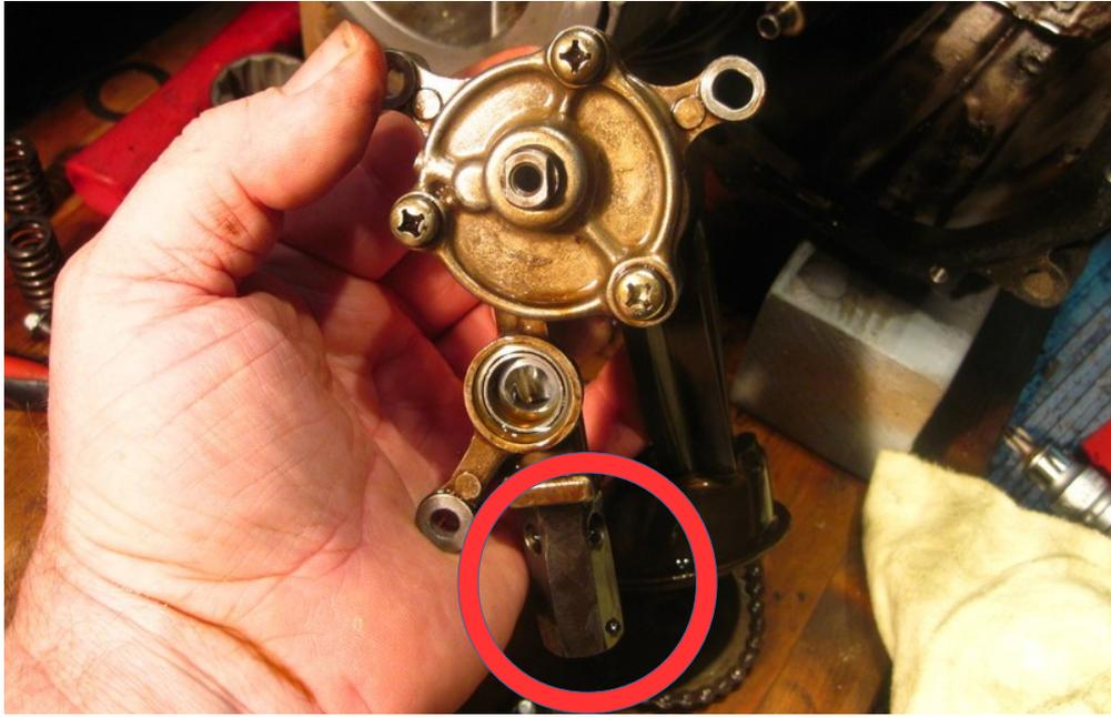
Das Ventil wird zur Überprüfung zerlegt und die Leichtgängigkeit der Teile kontrolliert. Als erstes habe ich die Ölpumpe kopfüber in einem Schraubstock fixiert. Der Federstift, der das Ventil zusammen hält, wird mit einem dünnen Austreiber ausgetrieben.
