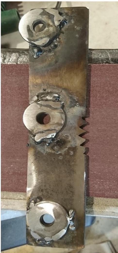
Mit Schlüsselfeilen habe ich dann die Konturen exakt nachgearbeitet und mit einem 8,5mm Bohrer die Löcher gebohrt. Nach einer kurzen Anprobe musste ich jedoch feststellen, dass der Blechstreifen noch etwas Luft zum Motorgehäuse hatte und sich so nicht hätte festschrauben lassen. Also habe ich noch M8 U-Scheiben hinten draufgebracht. Nicht schön, aber selten, und es hält. Mit dem Bandschleifer abgeschliffen, und - tada: Kurbelwelle blockiert!
