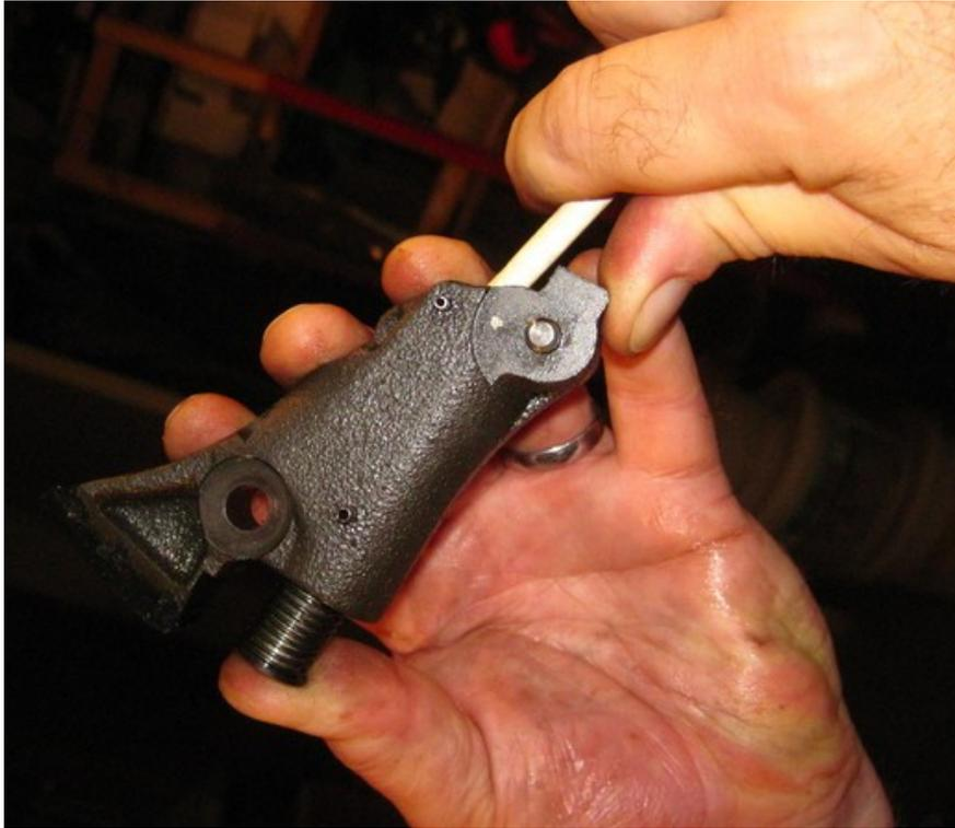
Dadurch kommt der Stempel frei und lässt sich reindrücken. So zusammengedrückt lässt sich der Kettenspanner wieder einsetzen.
