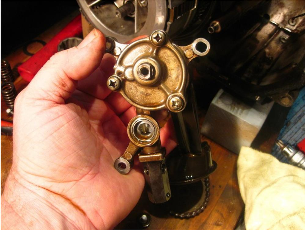
Sie lassen sich leicht rausschrauben und der Deckel des Ölpumpengehäuses kann abgenommen werden. So sieht die Ölpumpe innen aus:
