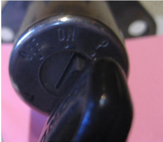
Es ist deutlich zu erkennen, dass der Schlüssel mittig zwischen ON und P steht.
