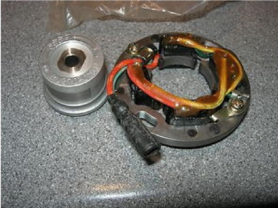
Das Massekabel kann in dem frei gewordenen Raum, in dem sich die Sensorplatte für die Frühverstellung befand, angeschlossen werden.
