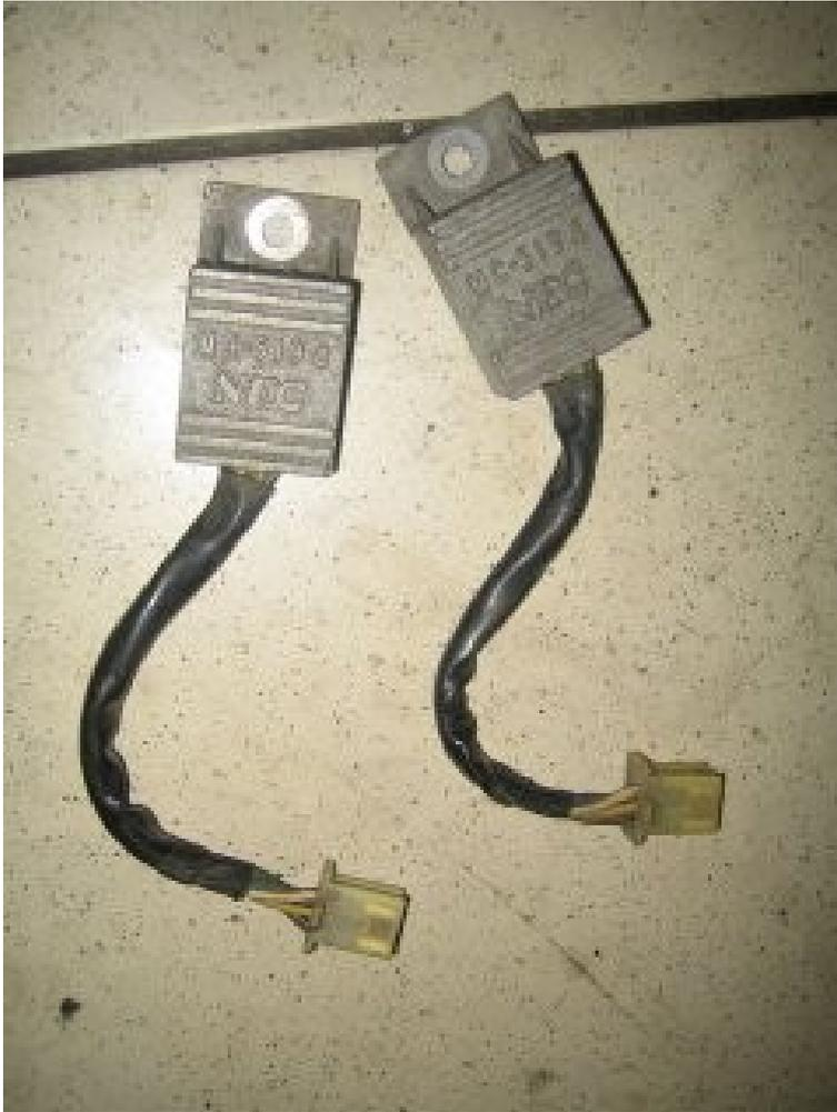
Bei NEC-Zündung befinden sich **zwei** graue Würfel unter der Sitzbank, die die Prägung **MC 5194** und darunter **NEC** tragen. Die sehen dann so aus:
