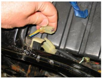
Trennen Sie zunächst den Stecker für die Pickup-Spule.
