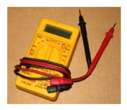
Auch ein billiges Multimeter hat eine Vielzahl von Messmöglichkeiten und entsprechender Einstellungen. Die überwiegende Anzahl von Problemen kann aber genau diagnostiziert werden, indem nur drei grundlegende Messarten benutzt werden: **Widerstandsmessung**, **Gleichspannungsmessung** und **Wechselspannungsmessung**. Weil der Multimetereinsatz so wichtig ist, ist es sinnvoll, ein paar Minuten mit der Betrachtung seiner Benutzung zu verbringen.
