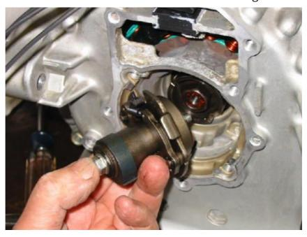
Das Werkstatthandbuch schreibt vor, dass die statische Zündzeitpunkteinstellung eingestellt und zwei mal überprüft wird, einmal wenn die Kurbelwelle links auf "FS" steht und noch ein mal, wenn sie für die rechte Seite auf "FS" steht. Wenn das gemacht wurde sollte der Nocken auf dem Rotor dem dem Nocken der entsprechenden Spule gegenüberstehen. Wenn die mechanische Zündvorverstellung falsch zusammengebaut oder falsch eingebaut wurde werden sie nicht einmal annähernd übereinstimmen.
