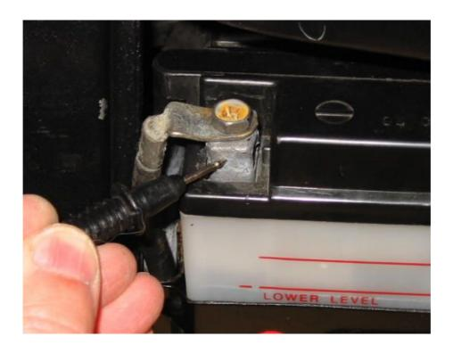
Wenn man diesen Punkt auswählt hat man die beste Masseverbindung, ganz gleich, welche Masseverbindungen sonst am Motorrad noch vorhanden sind. Das vereinfacht die Fehlersuche im Falle einer fehlerhaften Masseverbindung irgendwo am Motorrad.
