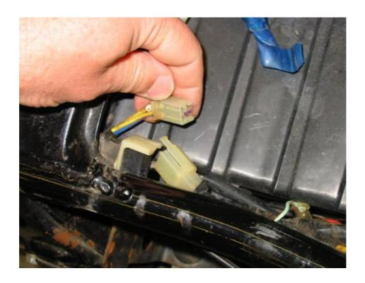
Trennen Sie den Stecker, um die Widerstandsmessungen durchzuführen. Machen Sie diese Messungen auf der Seite, die zum Motor führt, nicht auf der zu den Zündmodulen. Die Seite, auf der gemessen werden muss ist die, die auf dem Foto in der Hand gehalten wird.
