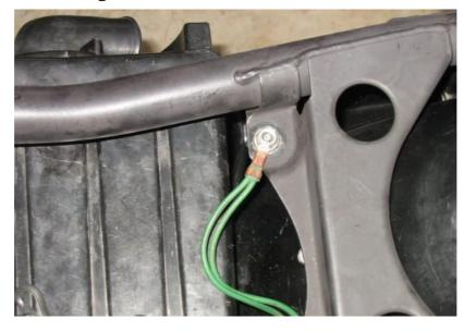
Beachten Sie bitte, dass hier im Gegensatz zur GL 500 zwei Drähte an den ringförmigen Kabelschuh gecrimpt sind. Inzwischen kennen Sie ja die 08/15-Methode - Herstellen einer guten Verbindung zum blanken Metall und die Mutter mit dem vorgeschriebenen Drehmoment anziehen, damit sie nicht los vibriert.
