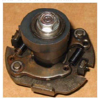
Wenn der Zusammenbau in dieser Weise erfolgt, kann sich die Befestigung lösen, wenn der Motor einige Zeit läuft:
