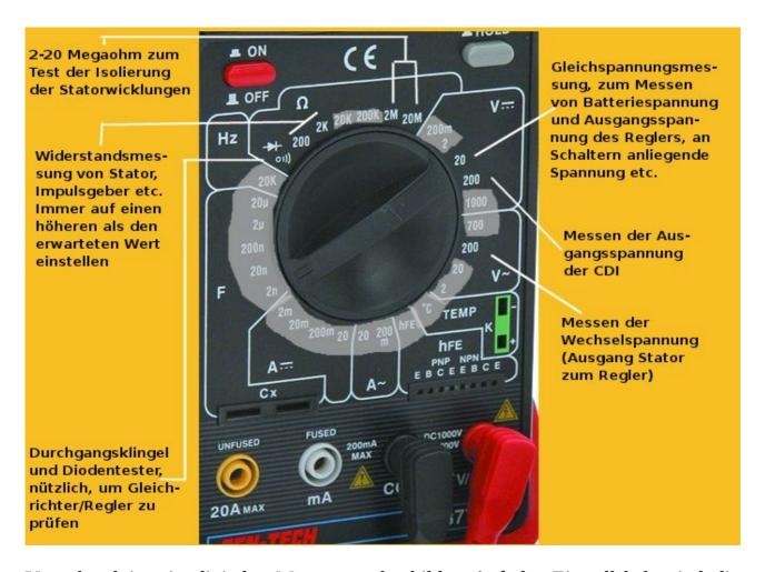
Vorstehend ist ein digitales Messgerät abgebildet. Auf der Einstellskala sind die Bereiche markiert und dargestellt, die üblicherweise für die Messungen an einer CX/GL benötigt werden.
