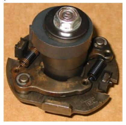
Wenn die Unterlegscheibe weggelassen wird oder eine kleinere Scheibe verwendet wird, ist das Ende des Mechanismus nur teilweise bedeckt:
