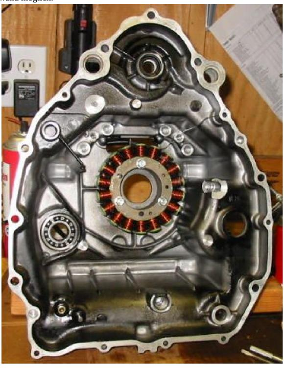
Die Messung mit dem Multimeter erfolgt am Statorverbindungsstecker, wobei dieser getrennt sein muss.
