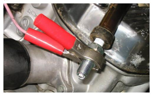
Als nächstes prüfen Sie den Kontakt für das weiße Kabel des Zündmoduls, das für die zu testende Seite zuständig ist. Ein kurzes Stück Schweißdraht tut hier gute Dienste. Benutzen Sie ein Messkabel oder einen Draht um die Verbindung herzustellen.
