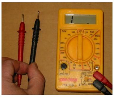
Um Widerstände größer als 200 Ohm zu messen, muss das Messgerät umgeschaltet
