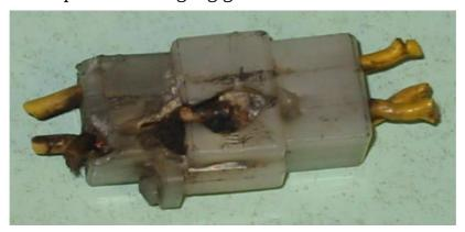
Ziehen Sie den Stecker ab und untersuchen Sie beide Hälften sehr sorgfältig auf Anzeichen von Überhitzung, Spannungsüberschlägen, Korrosion und gebrochene oder ausgefranste Kabel. Eine gut leitende Verbindung aller drei Drähte ist hier unbedingt notwendig.
