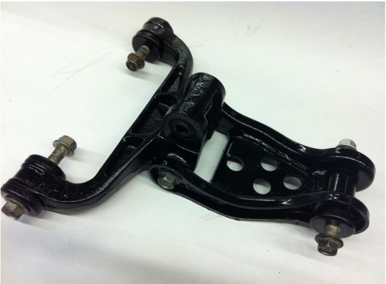
Einbaufertiger Zustand, Anzugsmoment der Schraubverbindungen: 55Nm.
