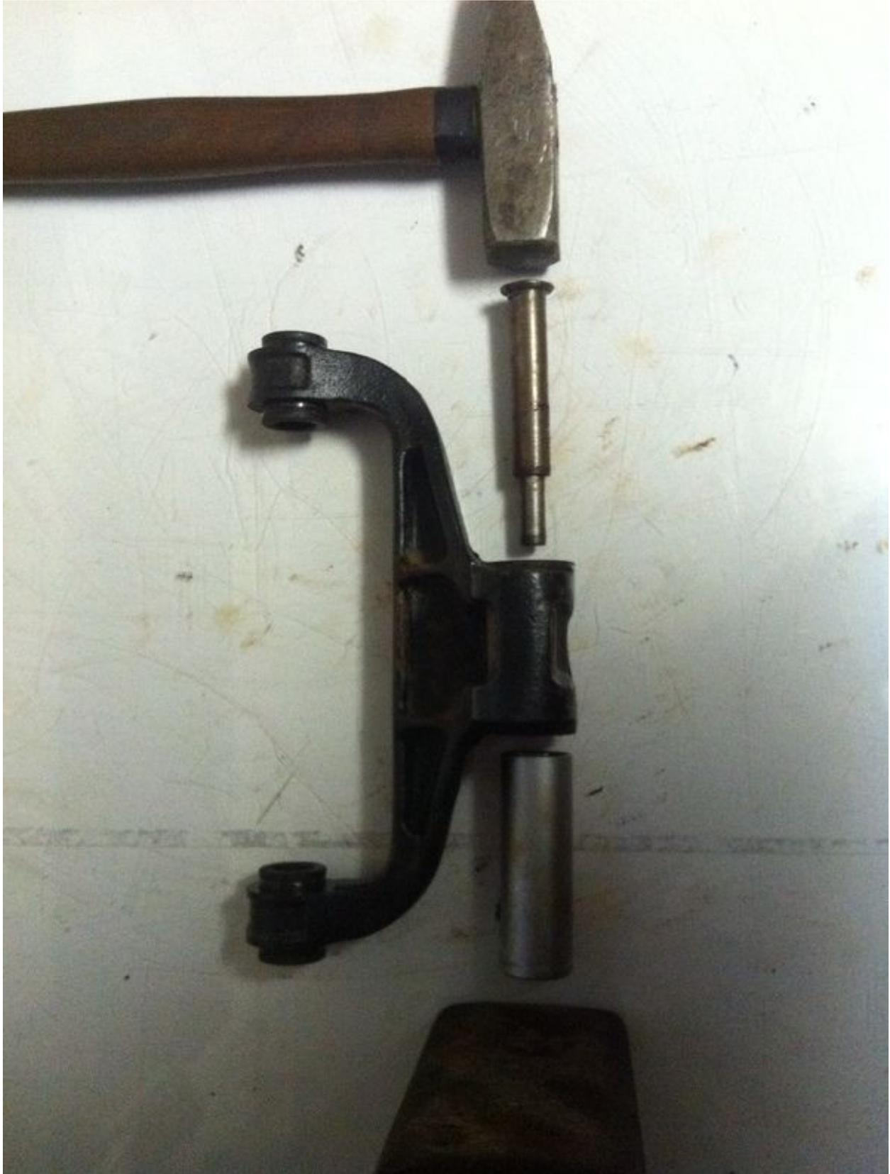
Achte drauf, dass der Hebel bei jedem Schlag plan auf der Nuss aufliegt!
