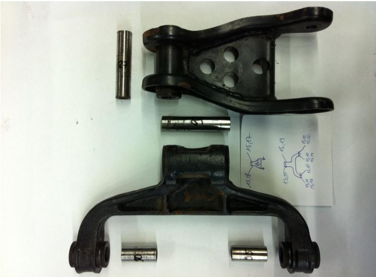
Serienmässig haben die Bolzen 14,95mm AußenØ, die Hülsen haben 15,10mm bis 15,15mm InnenØ, eine Ausnahme bilden die Kohlenstofflager, hier hinten am Schmiedehebel verbaut, diese haben 15,10mm-15,15mm AØ. Die Bolzen dazu haben dementsprechend ein AØ von knapp 14,98mm-15,00mm. Das Lagerspiel ist hier enger...
