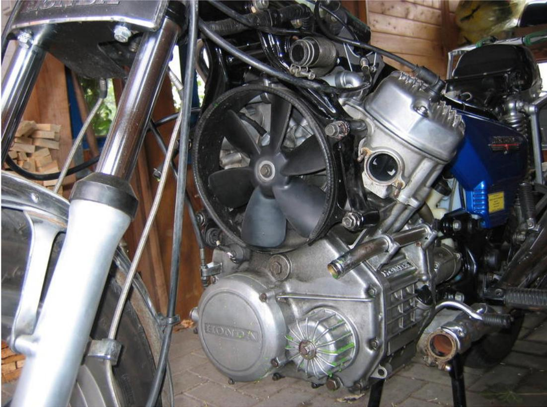
Zylindermantel Entwässerungsschraube links, Wasser ablassen:
