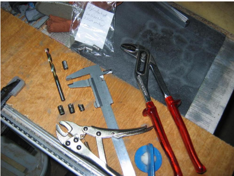
Glücklicherweise habe ich noch 4 Hülsen aus den Rumpfmotoren. Dabei ist mir aber aufgefallen, dass ich diese Hülsen nicht einfach in die Bohrlöcher der Köpfe stecken konnte. Diese waren auch durch Rückstände verengt. Ich habe sie dann mit einem Handbohrer auf 8mm aufgebohrt. Da
