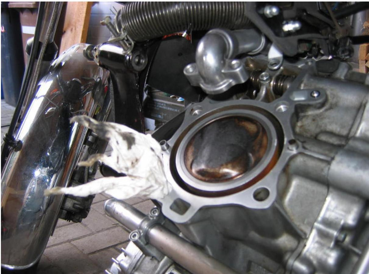
Das hatte ich dann rechts gemacht, aber links vergessen. Das fiel mir erst auf, als ich die Zylinderkopfschrauben zum ersten Mal rein schraubte und es etwas schwer ging. Dabei hatte ich dann schon Öl aus dem Loch gedrückt, das dann zwischen Dichtfläche und Dichtung gelaufen war - also alles noch Mal ab, reinigen und von vorn.
