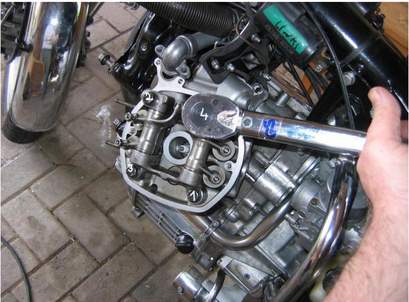
Ich habe die Schrauben immer im Wechsel mit einer Sechstel Drehung angezogen um eine möglichst gleichmäßige Verteilung des Drucks zu erreichen. Entsprechend erreichten alle Schrauben direkt nacheinander den Anzugspunkt.
