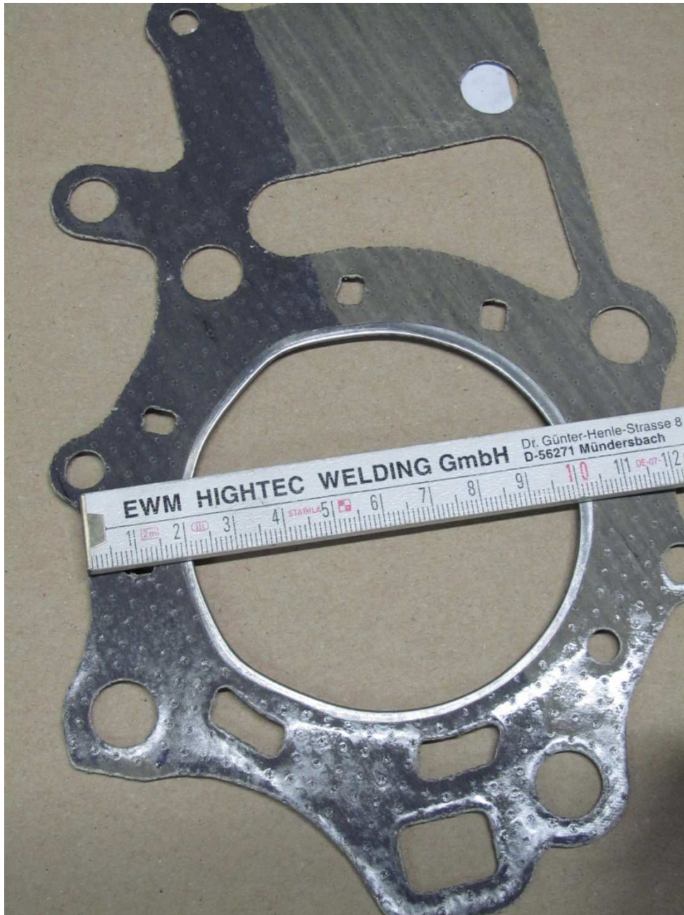
Bild 23: Athena Original, Rückansicht, zwischen 2 mm und 4 mm breiter Metallring
