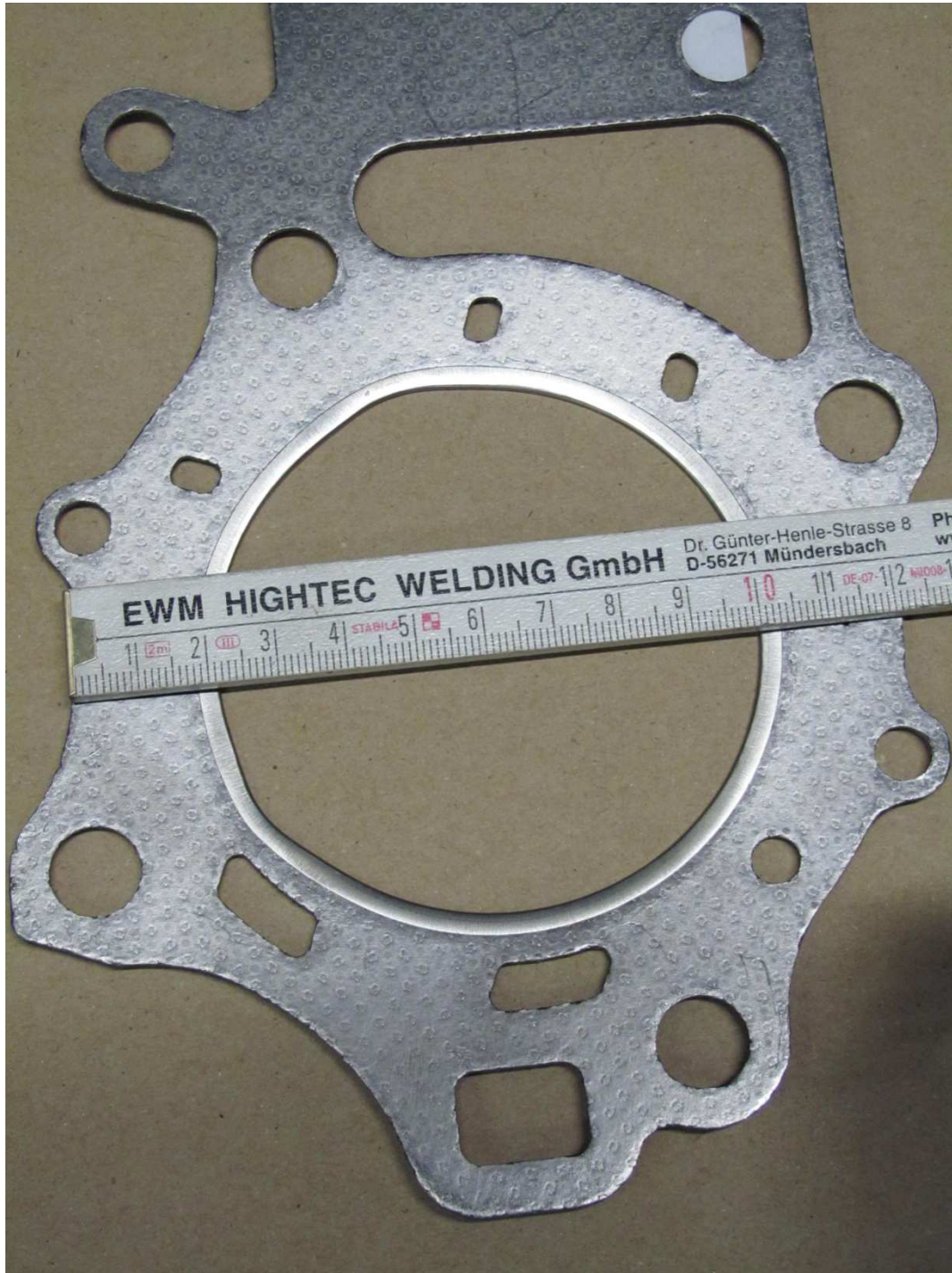
Bild 21: Honda Original, Rückansicht, zwischen 3 mm und 4mm breiter Metallring
