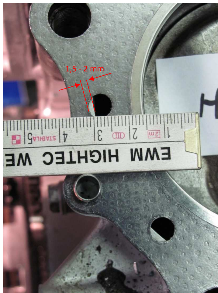
Bild 8: Wasserkanal ist versetzt gestanzt
