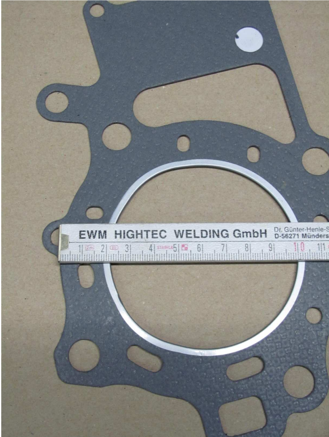
Bild 27: Asien, Rückansicht, zwischen 3 mm und 4 mm breiter Metallring
