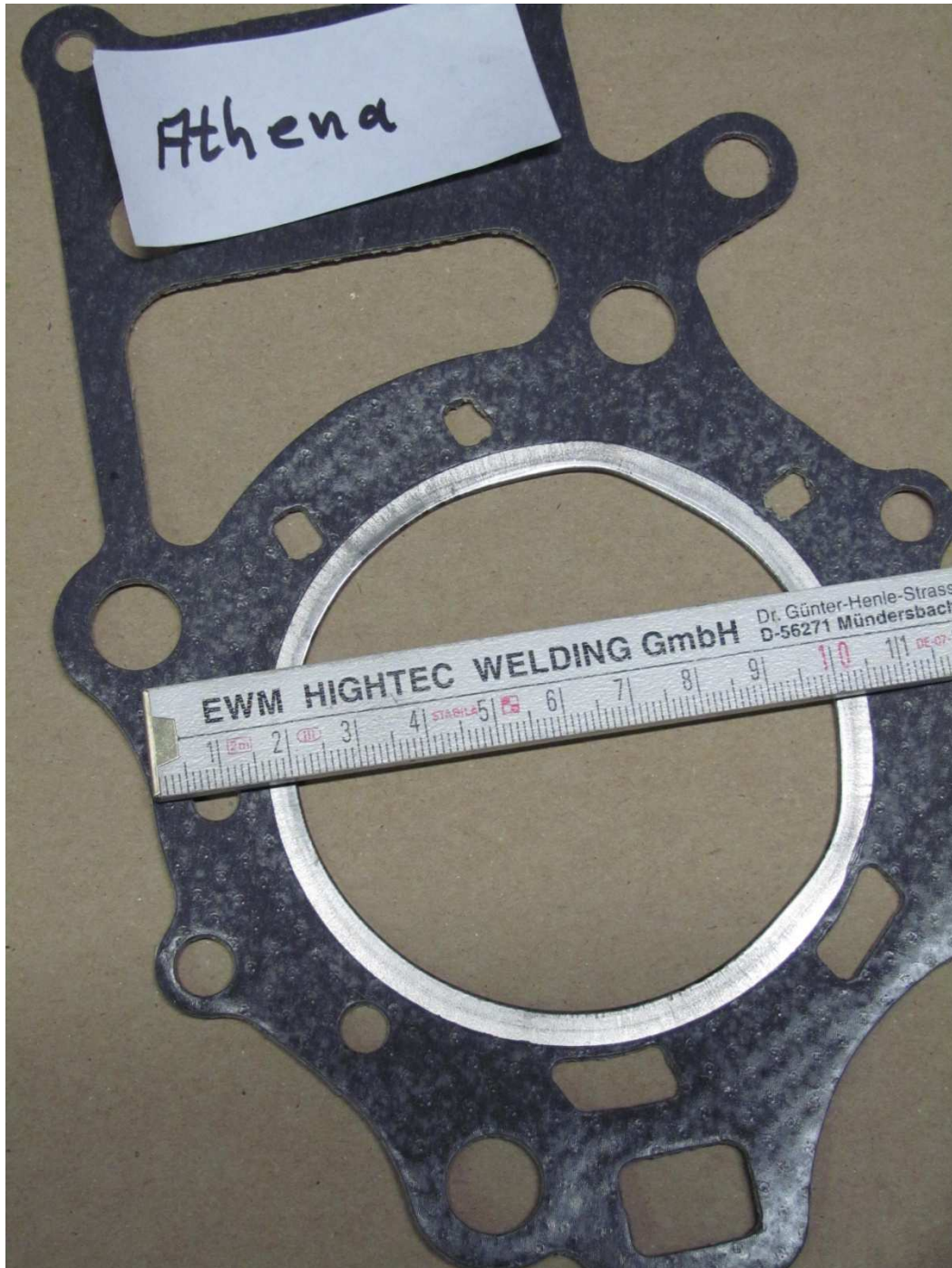
Bild 22: Athena Original, Vorderansicht, zwischen 4 mm und 6 mm breiter Metallring
