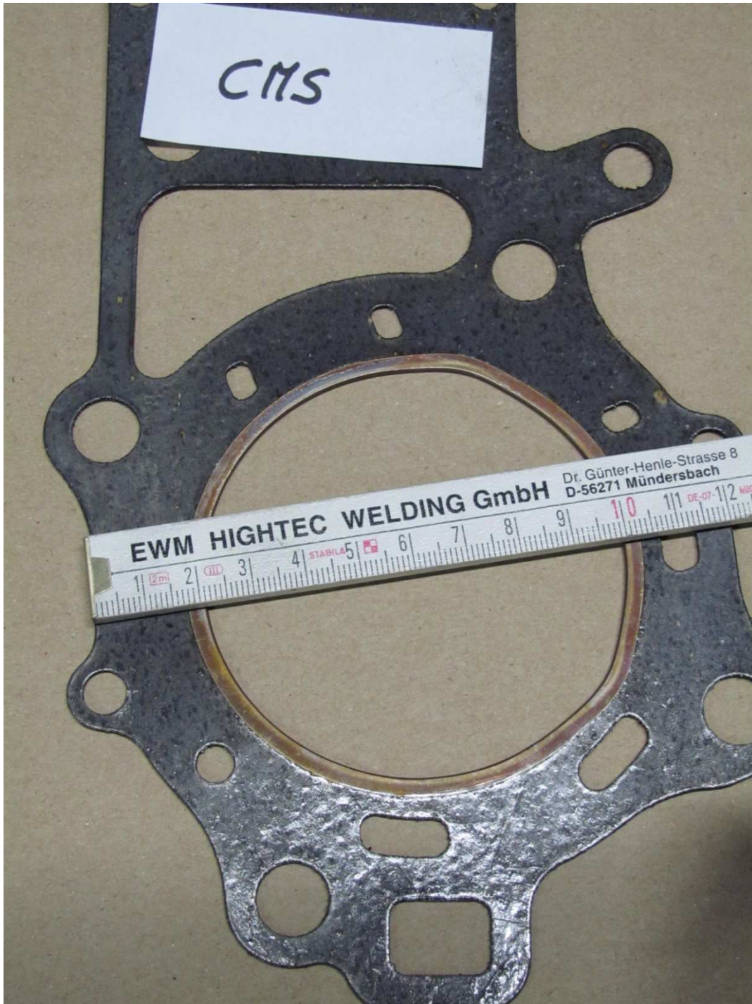
Bild 24: CMS (Honda), Vorderansicht, zwischen 3 mm und 4 mm breiter Metallring
