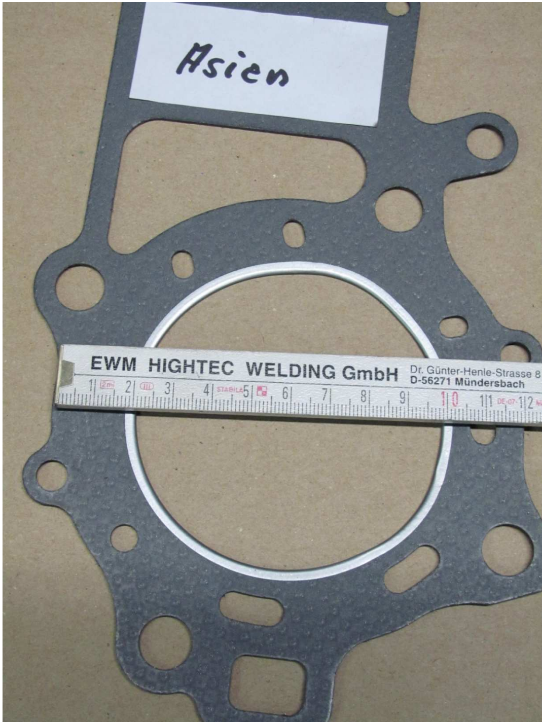
Bild 26: Asien, Vorderansicht, zwischen 3 mm und 4 mm breiter Metallring
