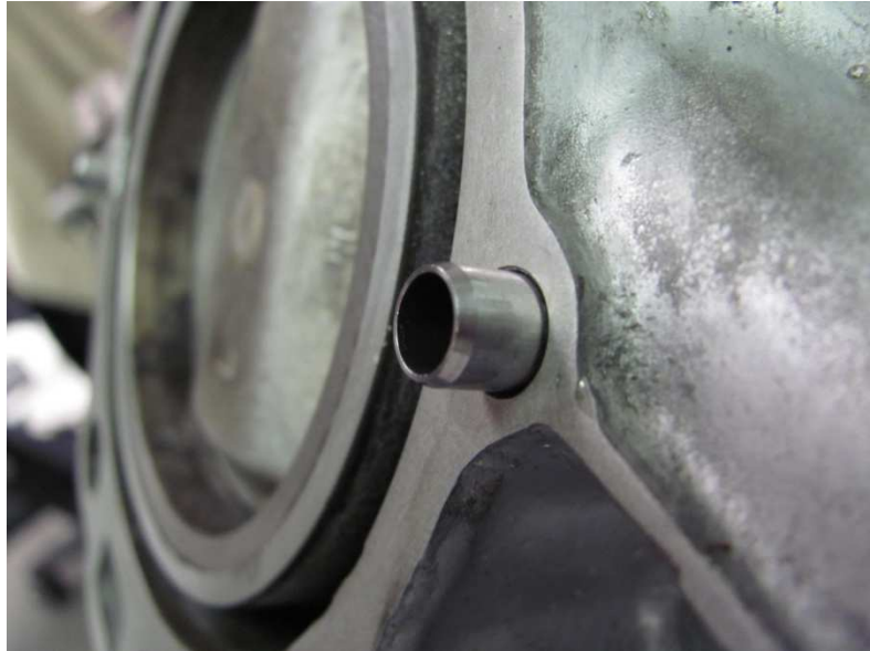
Bild 3 und 4: Passhülsen in den Motorblock eingesetzt
