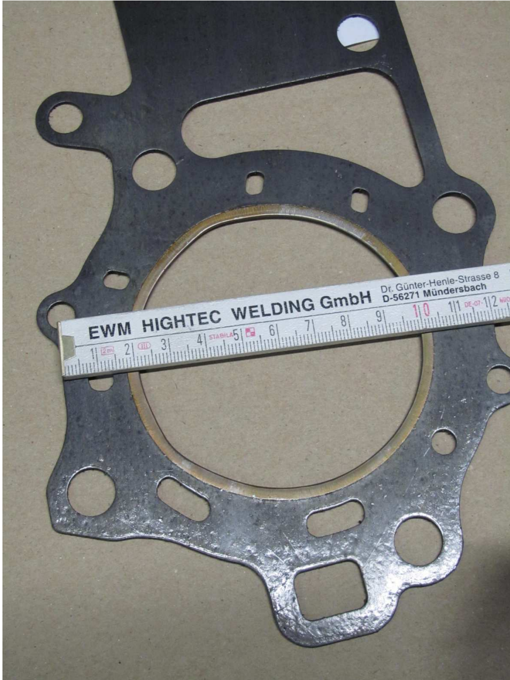
Bild 25: CMS (Honda), Rückansicht, zwischen 3 mm und 4 mm breiter Metallring
